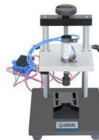
压盖机 Capping machine
