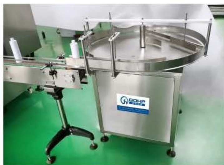
GHLP-H90 高速理瓶机 Auto high-speed bottle -unscrambler
