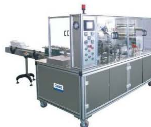
三维包装机 3-D cellowrapper
